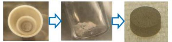
電解後の液体Cd陰極      再窒化回収粉末      (U,Pu)N焼結ペレット
