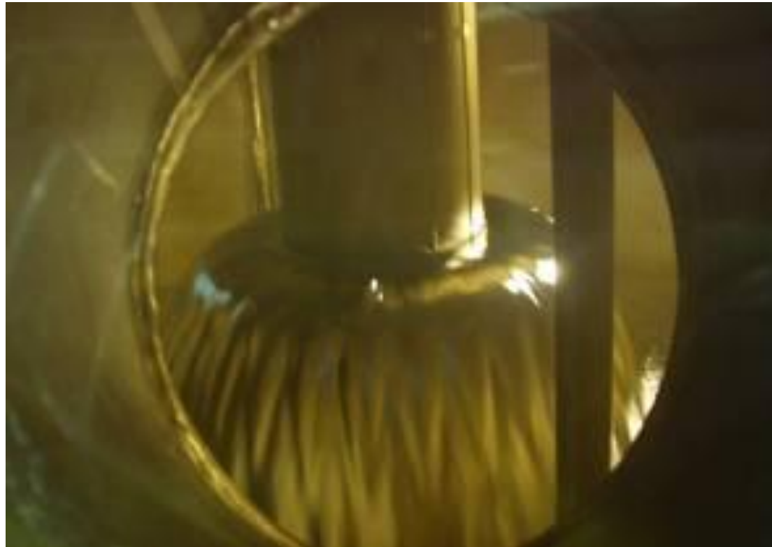
ビーム窓模擬ループのオーバーフロー部の流況
